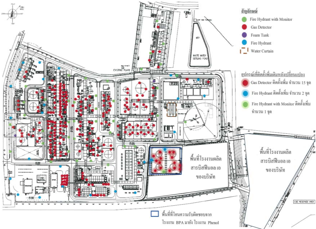
รูปที่ 2.8.4-1 ตำแหน่งของระบบป้องกันและระงับอัคคีภัย
